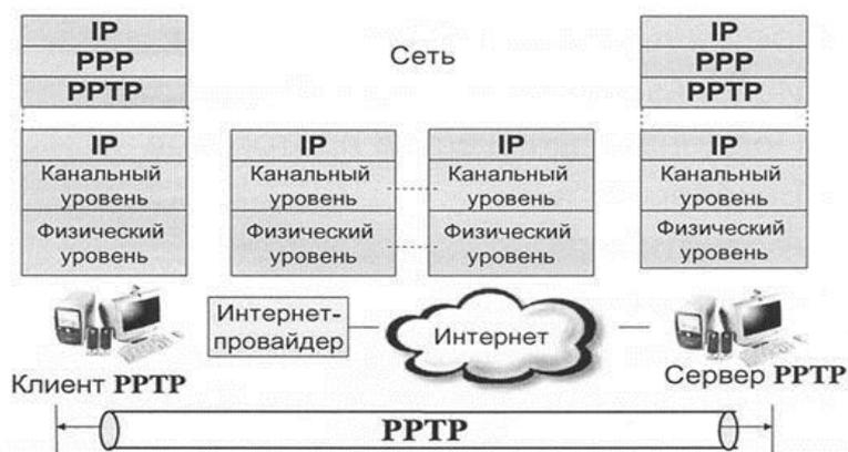
Рисунок 1.5 – Установление IP-соединения с туннельным сервером PPTP
